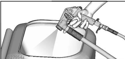
4. Azionare la pistola nel secchio per rifiuti finché il serbatoio non contiene più acqua e tutta l'acqua non sia rimossa dal sistema della pompa e dal flessibile.
