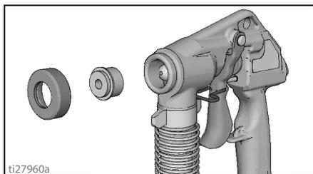
4. Aprire la valvola di controllo dell'aria della pistola, forzando l'aria attraverso l'ugello per eliminare tutto il materiale restante.
