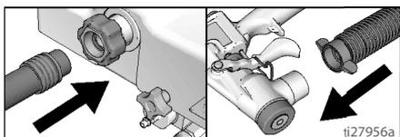
3. Installare l'ugello di spruzzatura. Vedere **Tabelle di selezione dell'ugello e del disco**, pagina 15. L'azionamento del grilletto durante l'installazione dell'ugello facilita l'assemblaggio.
